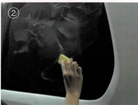
② ガラス表面をまんべんなく擦り、油膜が除去できている(液が弾かなくなる)事を確認してください。液の伸びが悪くなったら適時補水してください。
