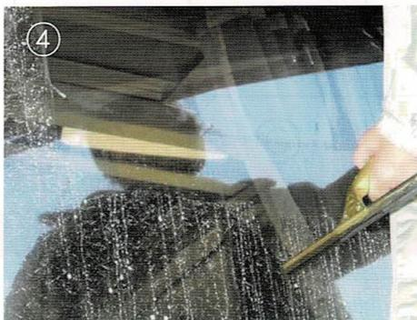
④ 研磨完了後、ガラス面を液剤が残らないようきれいなクロスで拭き取るか、水で洗い流してください。汚れが完全に落ちらない場合は、②③の作業を繰り返してください。
