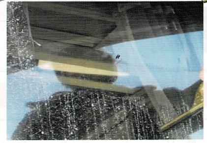
液剤が残らないようきれいなクロスで拭き取るか、水で洗い流してください。ハードパッド使用時は、1カ所だけを重点的に磨くと傷が入る恐れがありますのでご注意ください。
