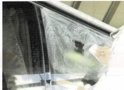
ガラスを軽く濡らし、パッドに液剤を適量付けて 30~40cm四方を磨きます。液の伸びが悪くなったら適時補水してください。
