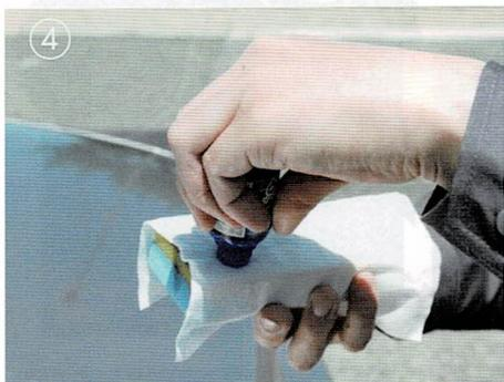
塗りのばしていき、ボデー表面が液で濡れているのが確認できなくなった段階で、5~10滴ほど不織布全体に液を足す。
