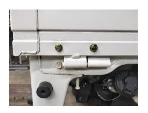
道路運送車両法に基づく軽自動車の車幅(車体から突き出る許容範囲は20mmまで)を クリアしており、違法ではない事を京都陸運局でも確認済みです。(装着したまま車検も通ります)
